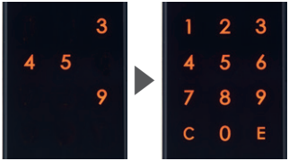
フェイクピン機能 (PAT) 先に表示されるフェイクの数字を消去してから暗証番号を入力しますので、暗証番号を特定されにくい設計です。
