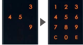
フェイクPIN機能 先に表示されるフェイクの数字を消去してから暗証番号を入力しますので、暗証番号を特定されにくい設計です。
