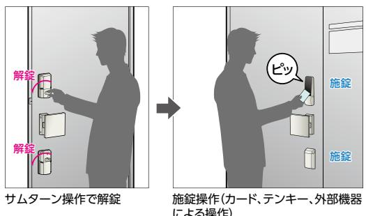
(注) 室内側からサムターンを操作して外出したときは自動施錠をしないため、簡単施錠やカードやテンキーによる施錠操作を行って、扉が施錠されたことを確認してください。
