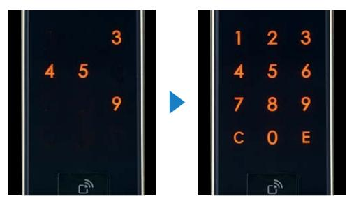
先に表示されるフェイク数字をタップして、すべて消去すると新たにテンキーが表示されます。
