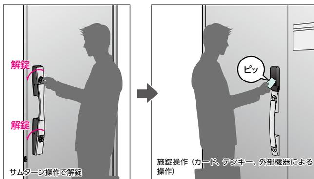
(注) 室内側からサムターンを操作して外出したときは自動施錠をしないため、簡単施錠やカード、テンキーによる施錠操作を行って、扉が施錠されたことを確認してください。
