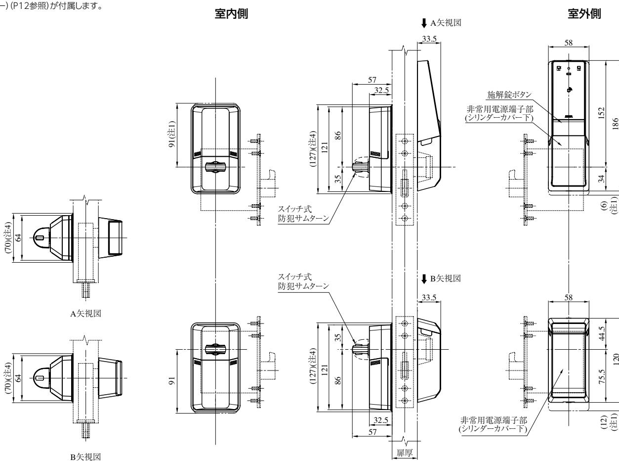
(注1) 扉によってはカバー開閉時にドアガードやハンドル等と干渉する場合がありますので、カバー開閉時の寸法を必ずご確認ください。
