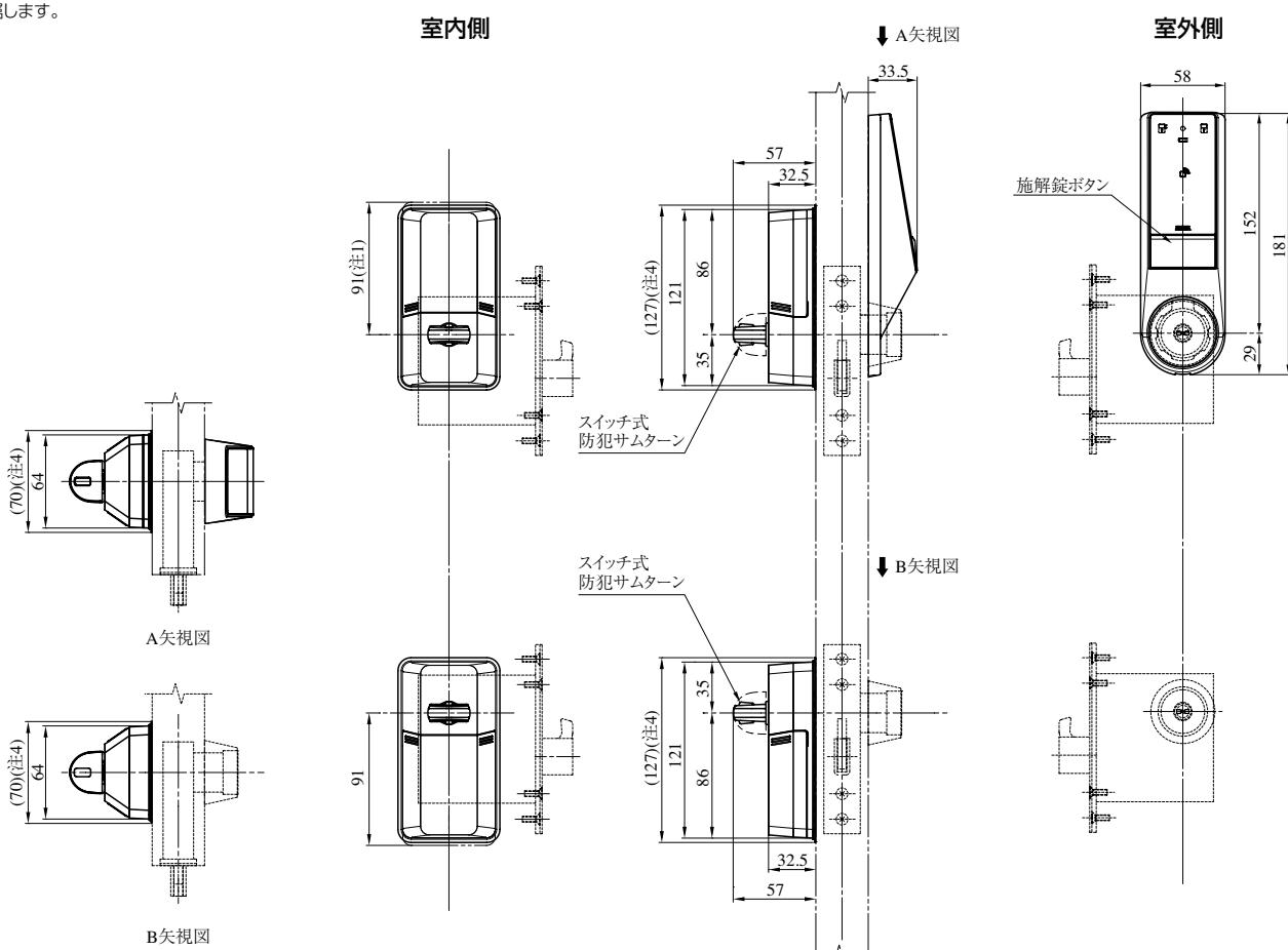
(注1)扉によってはカバー開閉時にドアガードと干渉する場合がありますので、カバー開閉時の寸法を必ずご確認ください。
