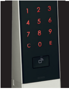
のぞき見防止機能 横からはテンキー表示が見えにくくなっています。
