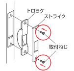
ストライクの正しい向き ストライクの向きに 注意して取り付けて ください。 角穴が下寄り
