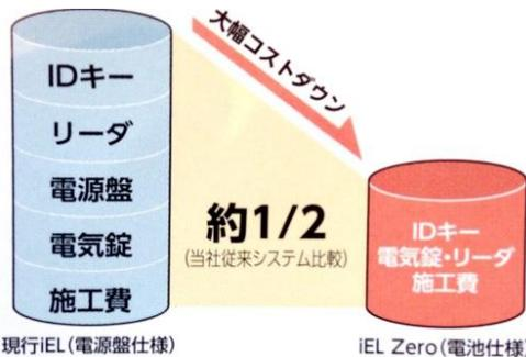
電池仕様の場合、扉～枠～電源盤の配線が不要となり、取り付けが簡単になります。またリーダが外側グリップと一体になっているため、リーダを別途取り付ける必要がありません。さらに機器構成を見直し、電気錠ケースも新たに開発し低コストを実現しました。
