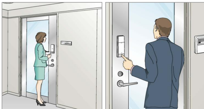
室外側からはリーダにカードをかざして入室(左)、室内側からはボタンを押して開錠(右)
