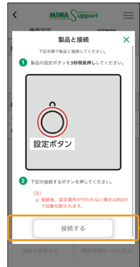
3 中継器の設定ボタンを3秒間長押し後、LEDが白色に点灯したら【接続する】をタップします。
