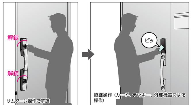
(注) 室内側からサムターンを操作して外出したときは自動施錠をしないため、簡単施錠やカード、テンキーによる施錠操作を行って、扉が施錠されたことを確認してください。
