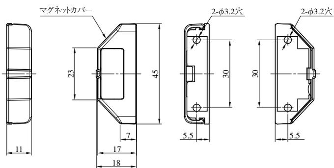
ドア開閉検知用マグネットの上端と、室内側ユニットの下端の位置を合わせて取り付けてください。
