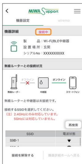
5 中継器と無線ルーターを接続します。接続できるSSIDのリストが画面に表示されます。表示しきれない場合は、スクロールしてご確認ください。
