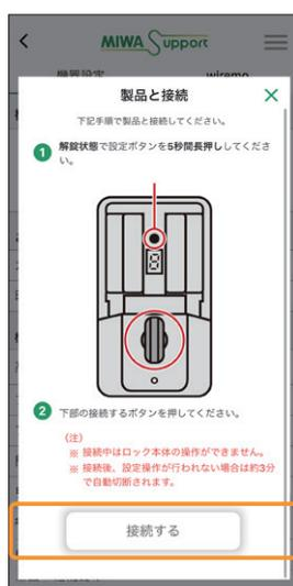
⑩ 設定ボタンを5秒間長押し後、表示部のLEDが点滅したら【接続する】をタップします。
