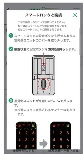
12 画面の指示に従って操作し、スマートロックと接続してください。
