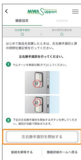
3 画面の指示に従ってサムターンを解錠位置に操作してから【左右勝手識別を開始する】をタップします。
